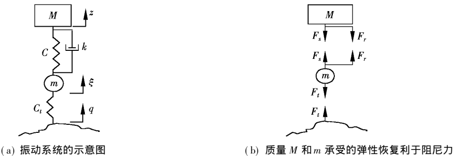
图1 车身与车轮两个自由度的汽车振动模型
