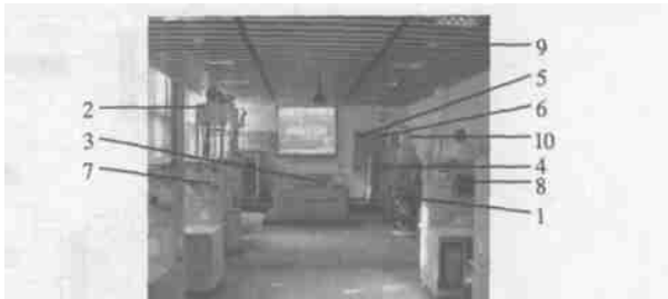
1, 中央空调子系统; 2, 电梯子系统; 3, 门禁管理子系统; 4, 消防报警和控制子系统; 5, 供电数据采集子系统; 6, 远程抄表子系统; 7, 计算机图像监控子系统; 8, VOD 点播子系统; 9, 综合布线子系统; 10, 照明控制子系统
