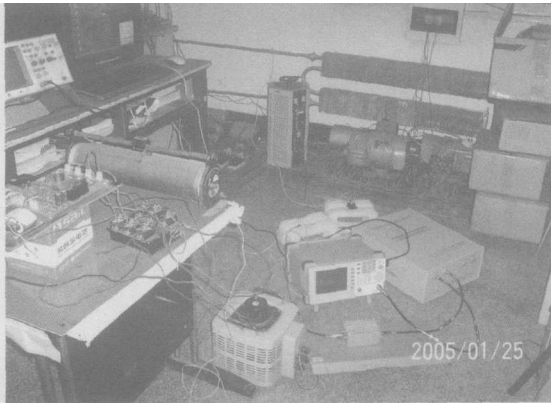
图 11 以开关磁阻电机调速系统为被测设备的实验装置图
