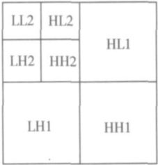
图 1 DWT 分解示意图 Fig.1 DWT analysis schematic diagram
