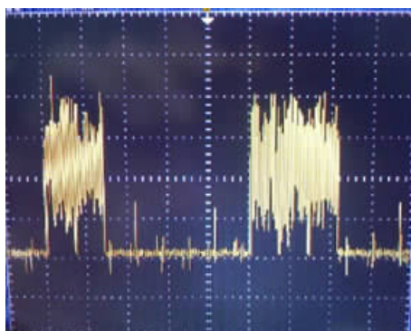
(a) 端接匹配阻抗前的输出波形
