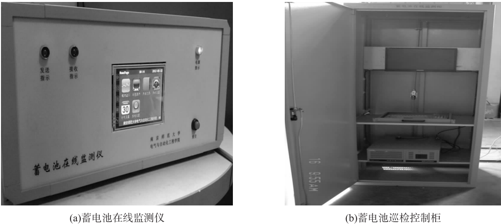
图 5 装置实物图 Fig. 5 Photo of the battery online monitor system
