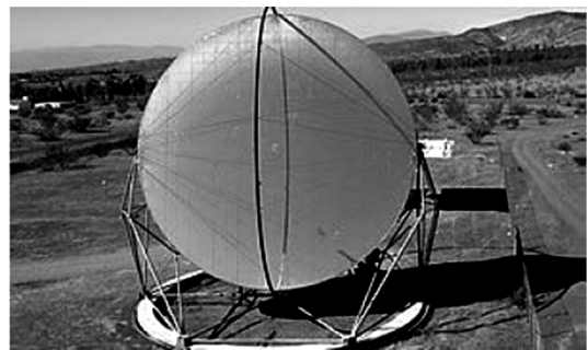
图3 金属膜反射镜 Fig.3 Metal membrane heliostat
