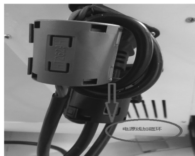
图 10 电源线加磁环
