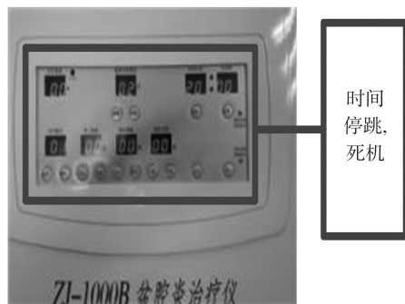
图 8 盆腔治疗仪在 4 kV 放电测试时屏幕死机
