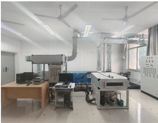
图 3 系统性能测试实验台实物图 Fig. 3 Physical diagram of system performance test
