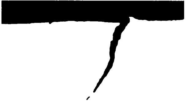
图2 裂纹萌生形态(300×)
