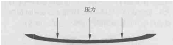
图 2 硅横隔膜受到均匀分析的压力后变形的截面图
