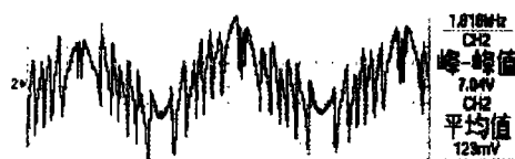
图5 正弦调制的自混合干涉信号
