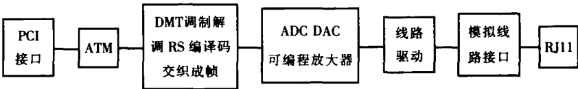
图 4 用户终端方框图 Fig.4 Framework of user terminal
