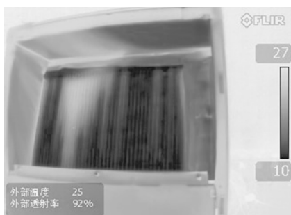
图 6 UF 方式蒸发器红外成像图
