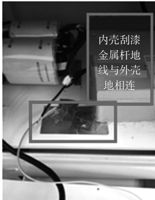
图5 金属棒地线连接到外壳地
