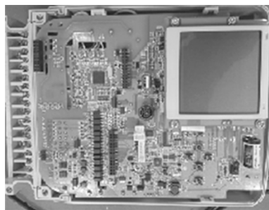
图4 集中抄表内部PCB电路
