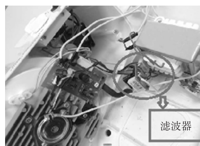
图6 针对电源噪声整改措施
