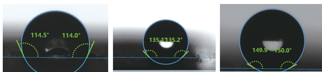
图 2 3 种疏水表面静态接触角
