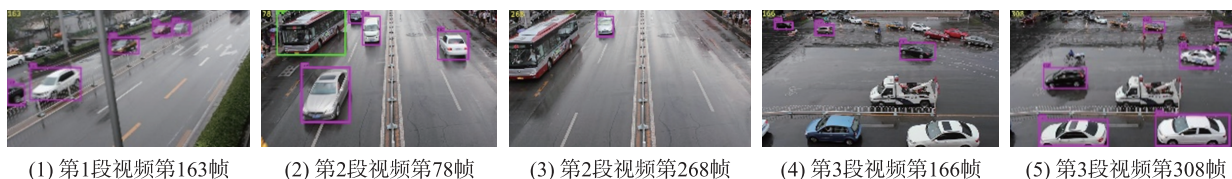
图 4 改进 YOLOv3 算法运动目标检测效果图
